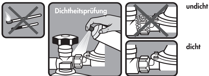
Abb. 2: Dichtheitsprüfung
