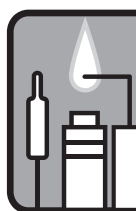
Abb. 4a: Wächterflamme brennt falsch
